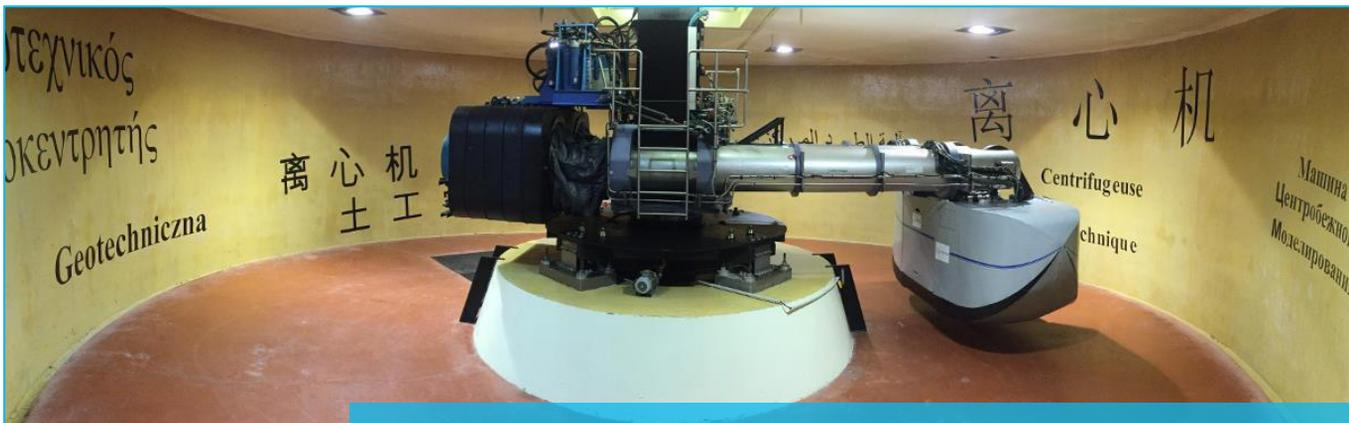
Centrifugeuse géotechnique de l'Université Gustave Eiffel équipée de sa nouvelle motorisation
